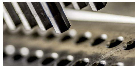
Ein in fest definierten Intervallen festgelegter Schliff der Werkzeuge sichert die Lochgüte
